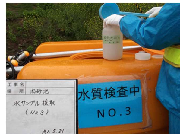
集水タンクからの採取状況
