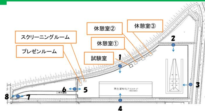
空間線量率の測定位置及び測定方向
