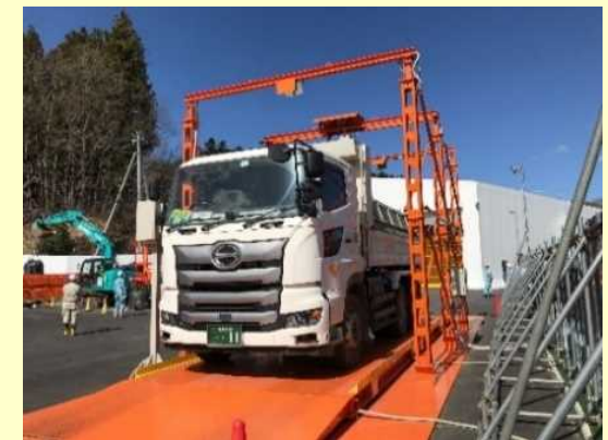
車載型放射能濃度測定装置 (NaI(Tl) シンチレーションスペクトロメータ1個) による放射能濃度測定状況
