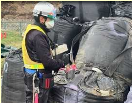
仮置場における放射線測定状況 (NaIシンチレーション検出器)
