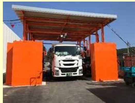
車載型放射能濃度測定装置 (NaI(Tl) シンチレーションスペクトロメータ8個) による放射能濃度測定状況
