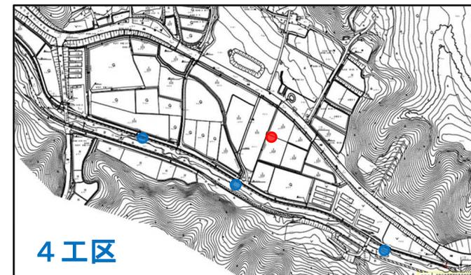
凡例 ● 盛土沈下測定 ● 土留擁壁定点測定
