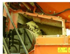
改質機の土砂詰りの状況
