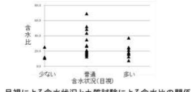
目視による含水状況と土質試験による含水比の関係
