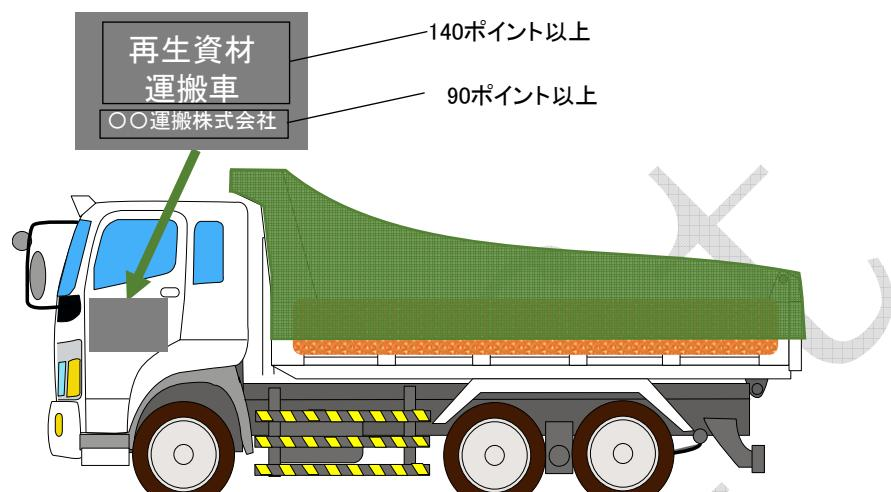
図6 運搬車の車体の外側の表示（例）
