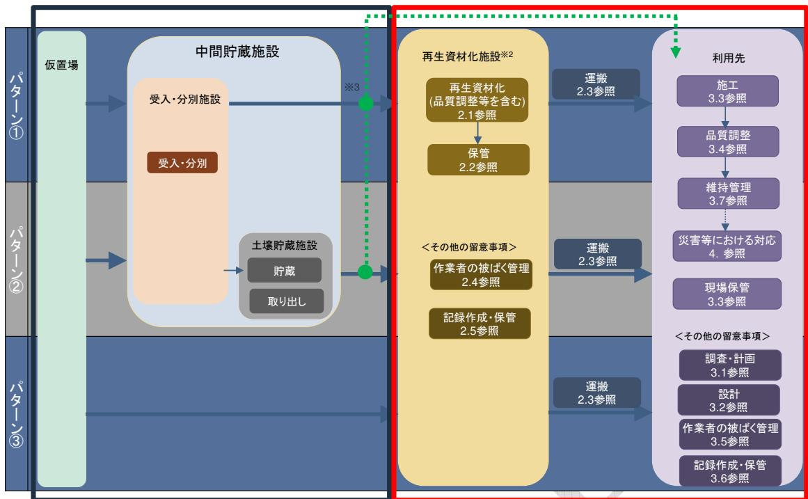
図2 再生資材化を実施する場所・タイミングに応じた処理の流れやその他の留意事項
