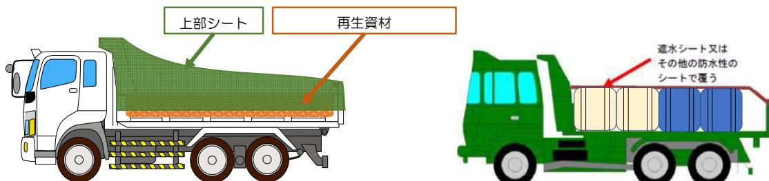
左図：運搬車の荷台を防水性シートで被うことにより、飛散・流出を防止した例
