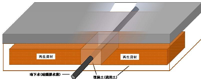
図9 管渠が横断している場合の施工方法の検討例（イメージ）
