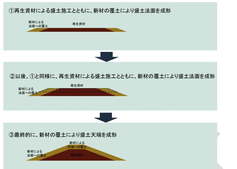
図 11 飛散・流出防止を図る施工法の例
