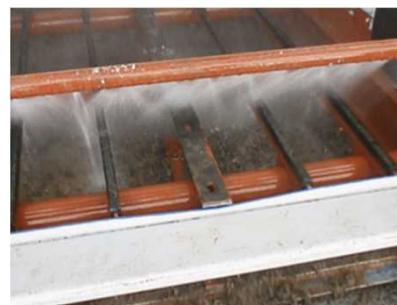
解泥後の土壌に水をかけながら、ふるいを振動させることで、主に「礫」を除去する設備
