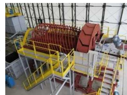
沈降分離により、砂と粘土・シルトを分別し、主に「砂」を除去する設備
