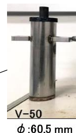
固型化カラム ガラス固化条件: 900°C × 3h
