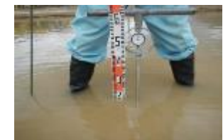
コーンペネトロメータによる 地耐力試験(上:無湛水,下:湛水)
