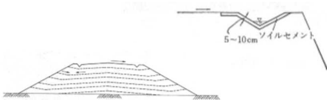
(b)のり面に雨水を出せない場合
