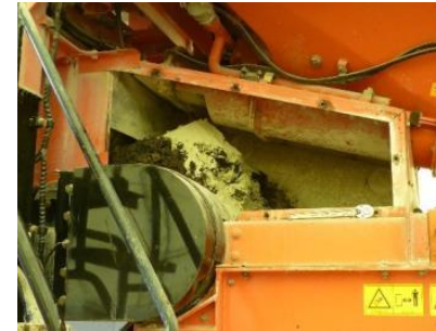
改質機の土砂詰りの状況
