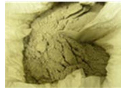
飛灰 (排ガス用フィルターに回収されたばいじん)
