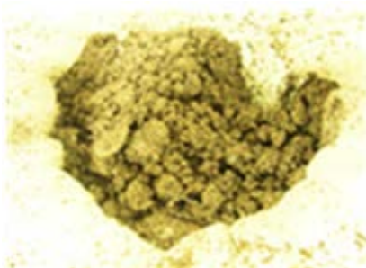
主灰 (焼却炉の炉底に残る灰)
