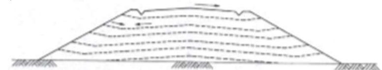
(b)のり面に雨水を出せない場合
