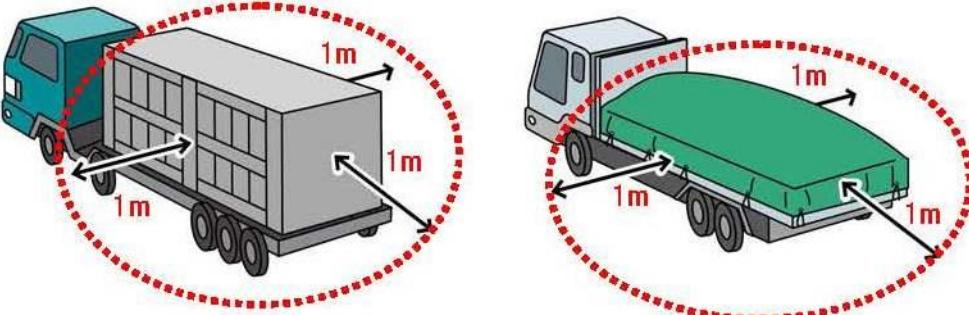
図3-14 輸送車両から1mの地点における空間線量率の試算例
