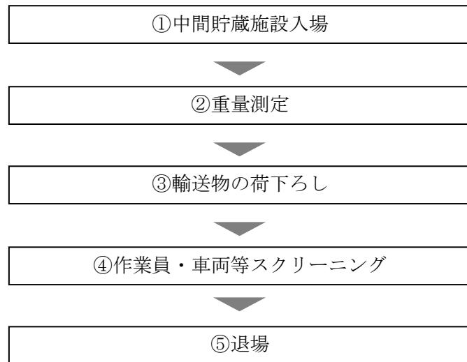
図 3-15 中間貯蔵施設における作業フロー
