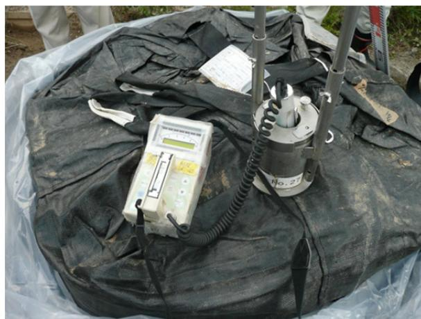
図 3-12 表面線量率の測定状況
