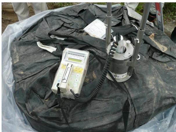
図 3-12 容器表面の放射線量率の測定状況
