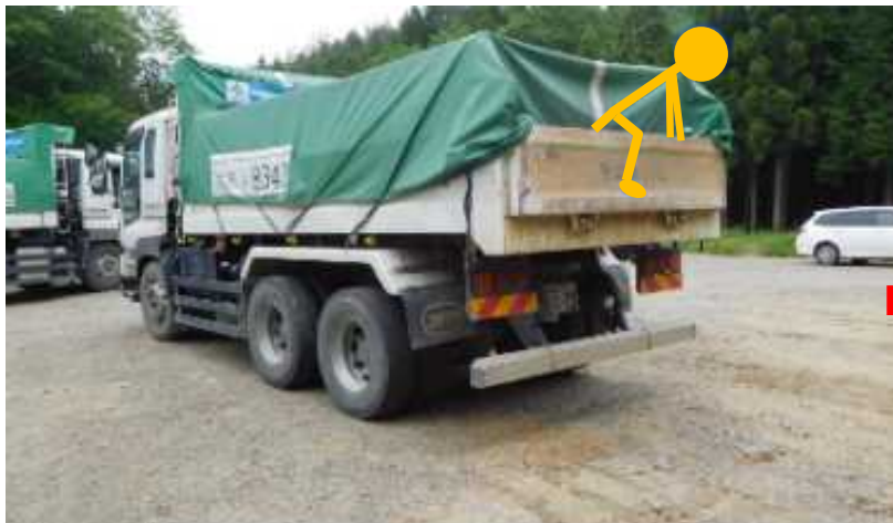
ダンプシートがかけられた状態で荷台上で点検していた。
