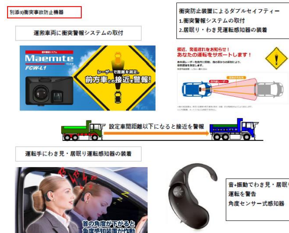
角度センサー式感知器及び衝突警報システム
