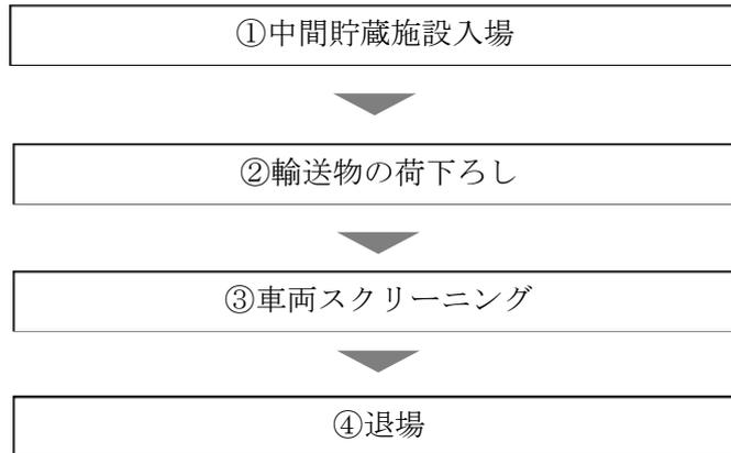
図 2.1.6-1 中間貯蔵施設における作業フロー
