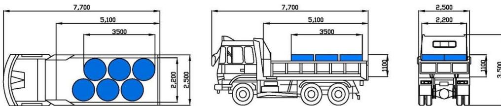
図 2.5.1-1 線源（積荷）の寸法
