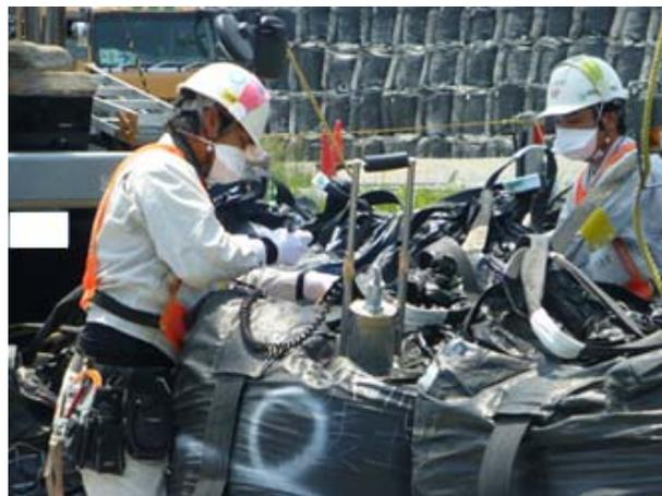
図 2.1.3-7 容器の表面線量率の測定状況
