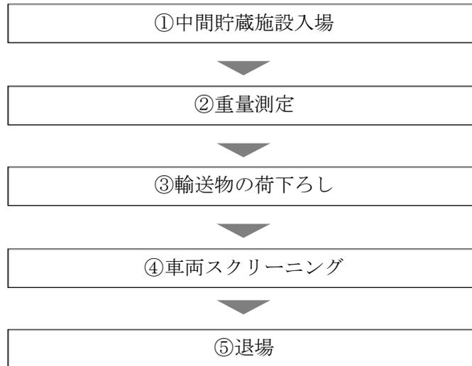
図 2.1.6-1 中間貯蔵施設における作業フロー
