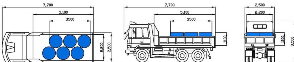
図 2.5.1-1 線源（積荷）の寸法
