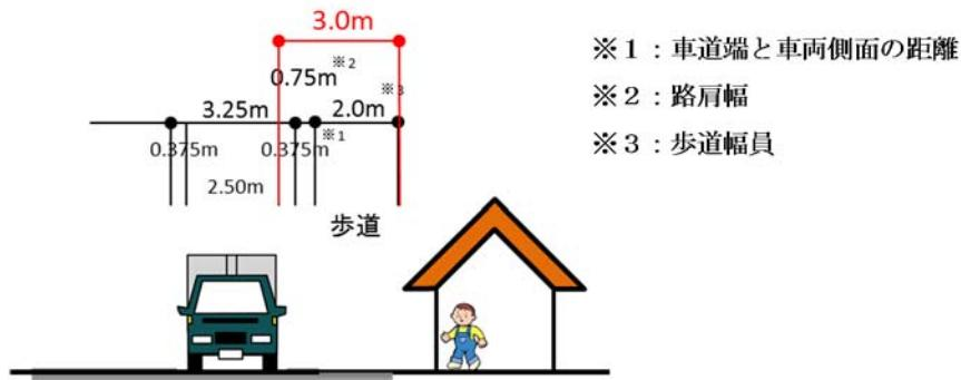
図 2.5.1-3 輸送車両の側面と沿道居住者との離隔
