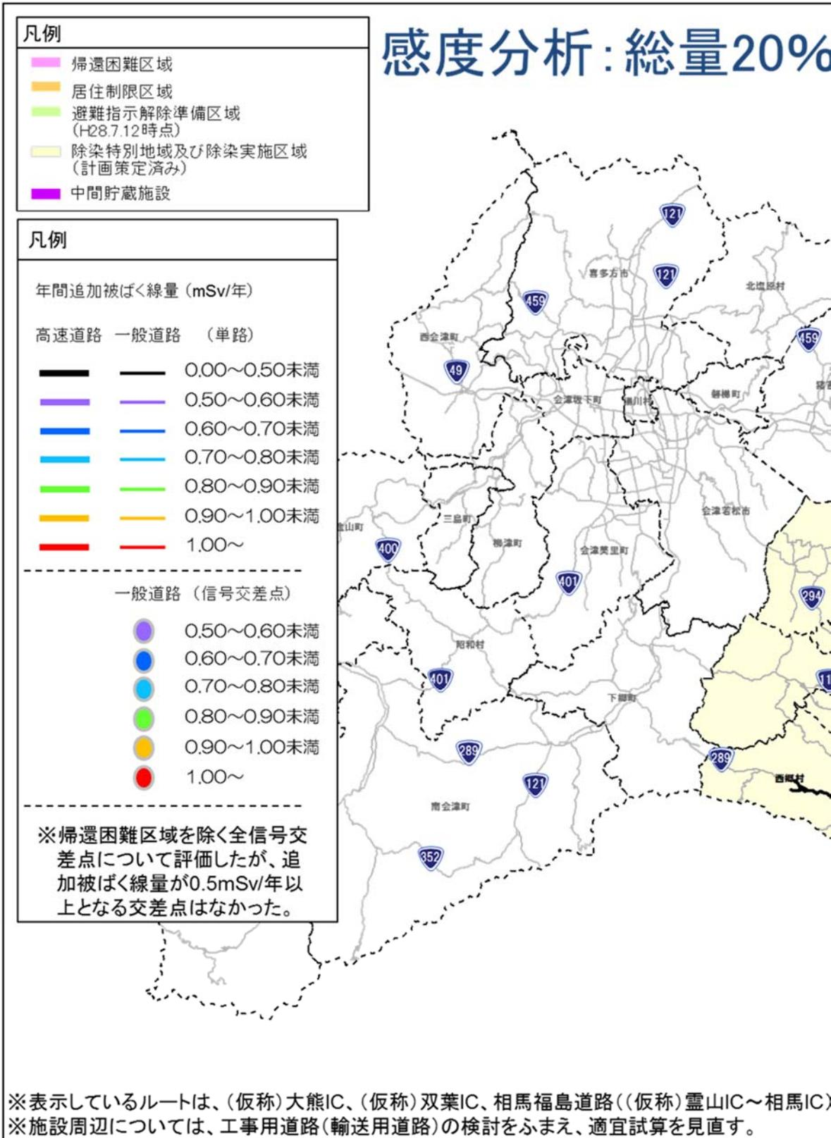
図 2.5.1-19 【感度分析：輸送量 20%増】本格輸送時「②被ばく：輸送による公衆の年間追加被ばく線量」の試算結果
