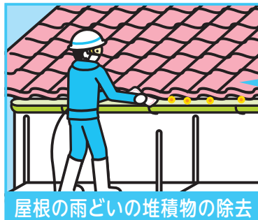
屋根の雨どいの堆積物の除去
